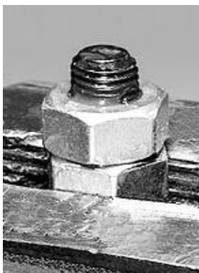
Рис. 3. Зразок різьбового з'єднання, підготовлений до випробувань
