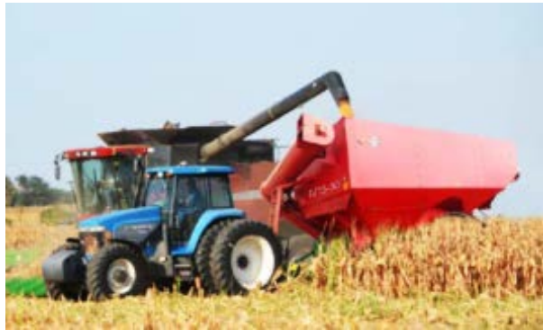
Рис. 1. Бункер-перевантажувач із бортовою системою для зважування
