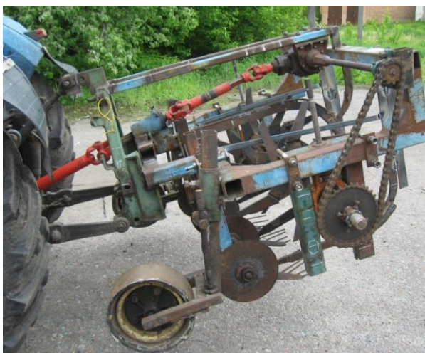
Рис. 6. Ґрунтообробна розрихлювально-сепаруюча установка з використанням пасивних дискових робочих органів
