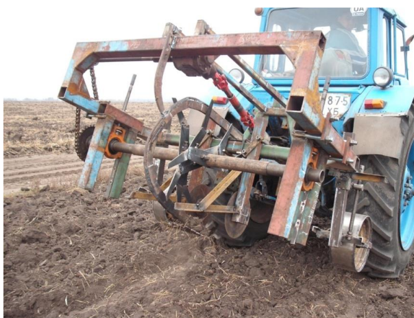
Рис. 7. Секція установки, що має можливість зміни відстані між дисками
