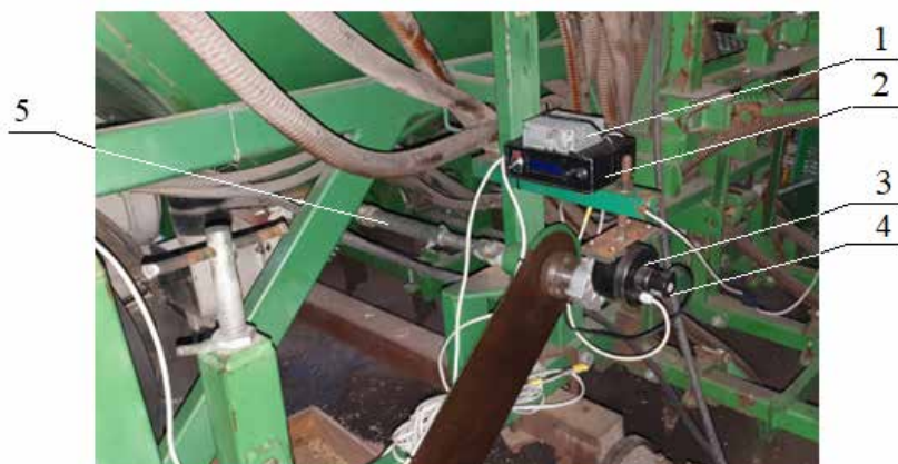
Рис. 4. Установка експериментального силового електроприводу на сівалці: 1 – блок живлення; 2 – електронний блок управління; 3 – електродвигун MY1016Z2; 4 – енкодер електродвигуна; 5 – вал висівного апарату
