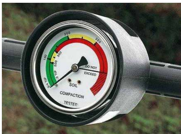
Рис. 2. Шкала пенетромтра (зовнішня шкала для наконечника ¼ дюйма; внутрішня шкала для наконечника ½ дюйма)
