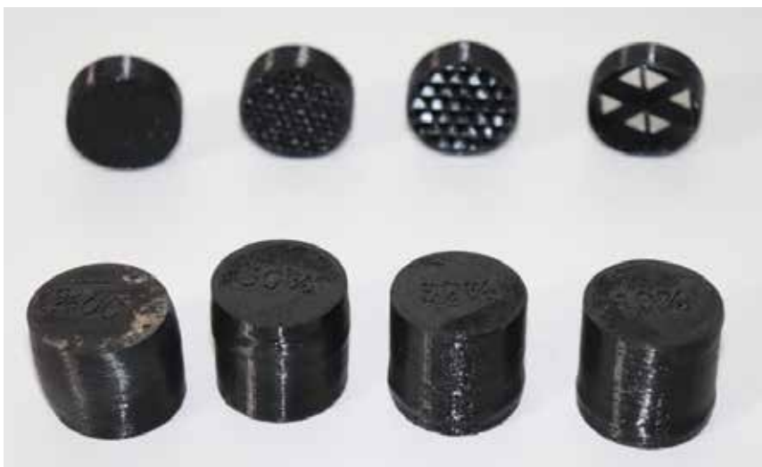
Рис. 2. Зразки після випробувань на стиск
