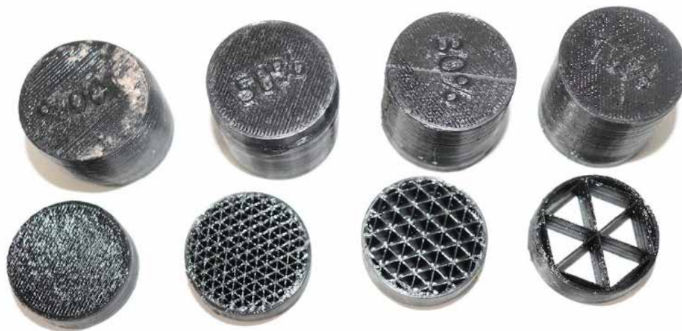
Рис. 1. Зразки композитних сотових конструкцій, \varnothing 30 \times H 40
