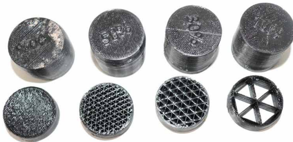
Рис. 1. Зразки композитних сотових конструкцій, \varnothing 30 \times H 40
