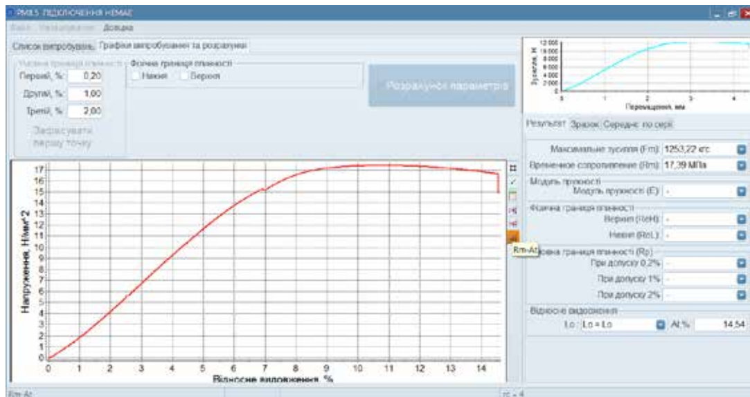
Рис. 4. Крива деформування зразка №2 (Q=50%)
