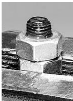
Рис. 3. Зразок різьбового з'єднання, підготовлений до випробувань
